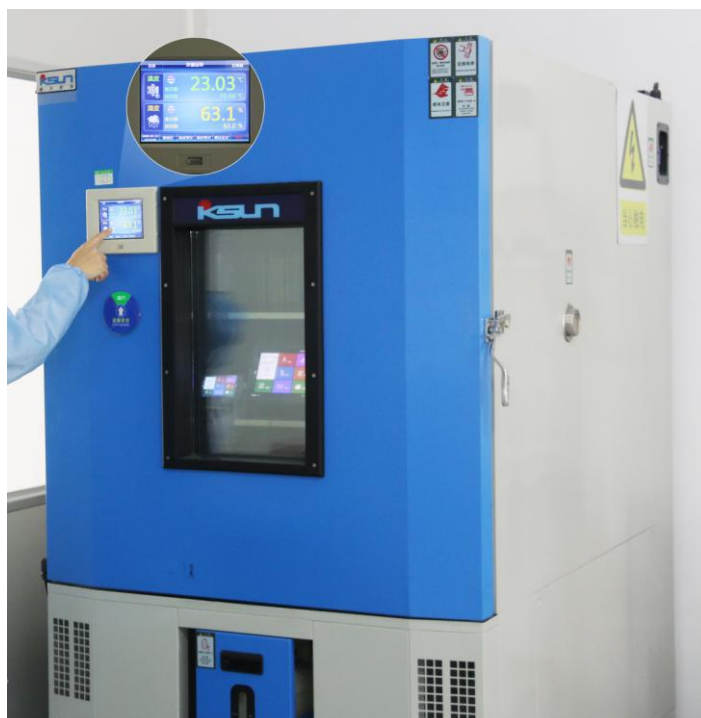
图 4-8 高低温老化测试图
